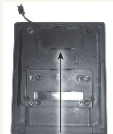
Отсек для батареек 2шт. 1.5V/AAA батарейки
